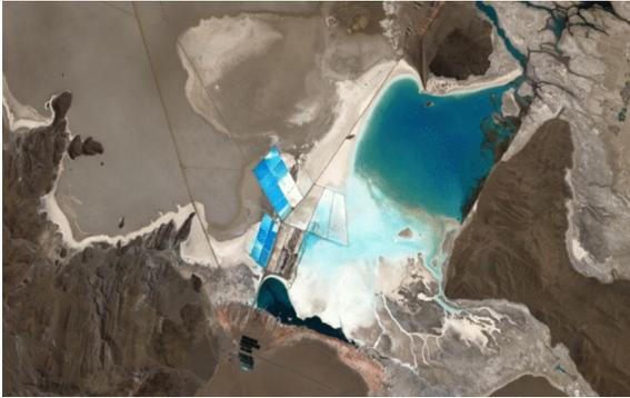
Con el fin de extraer la salmuera la empresa LIVENT realiza perforaciones y obtiene 900 m<sup>3</sup>/hora de salmuera del centro del salar, las cuales se depositan en unos piletones.
